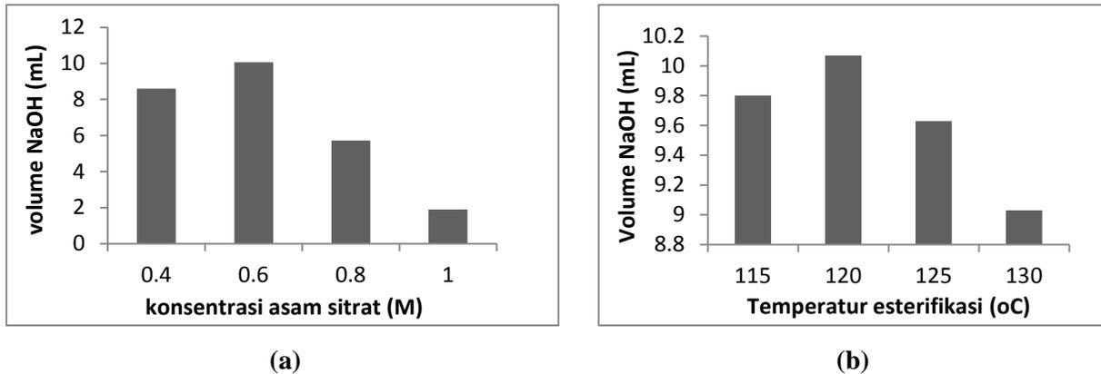
**Gambar 1.** Hasil analisis volumetri BA-Sitrat dengan NaOH 0,1M. (a) pengaruh konsentrasi asam sitrat. (b) pengaruh temperatur esterifikasi
